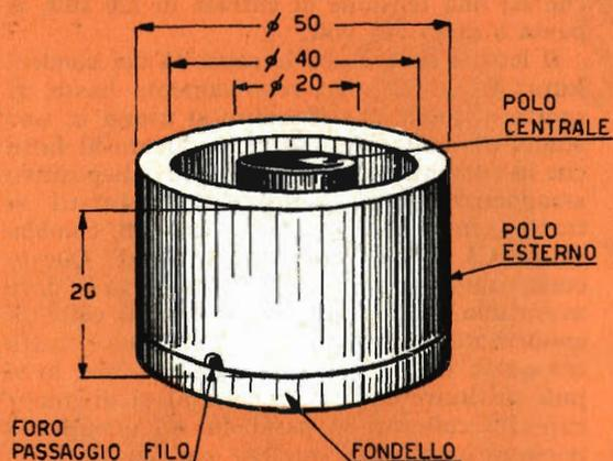
Fig. 3 - La bobina L1 è avvolta su nucleo di ferrite del tipo ad « olla ». Tale nucleo è costituito da tre pezzi separati: un nucleo (polo centrale), un anello (polo esterno) e un dischetto (fondello).
