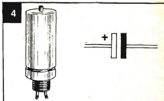
che nell'involucro cilindrico sono racchiusi due condensatori elettrolitici insieme.
