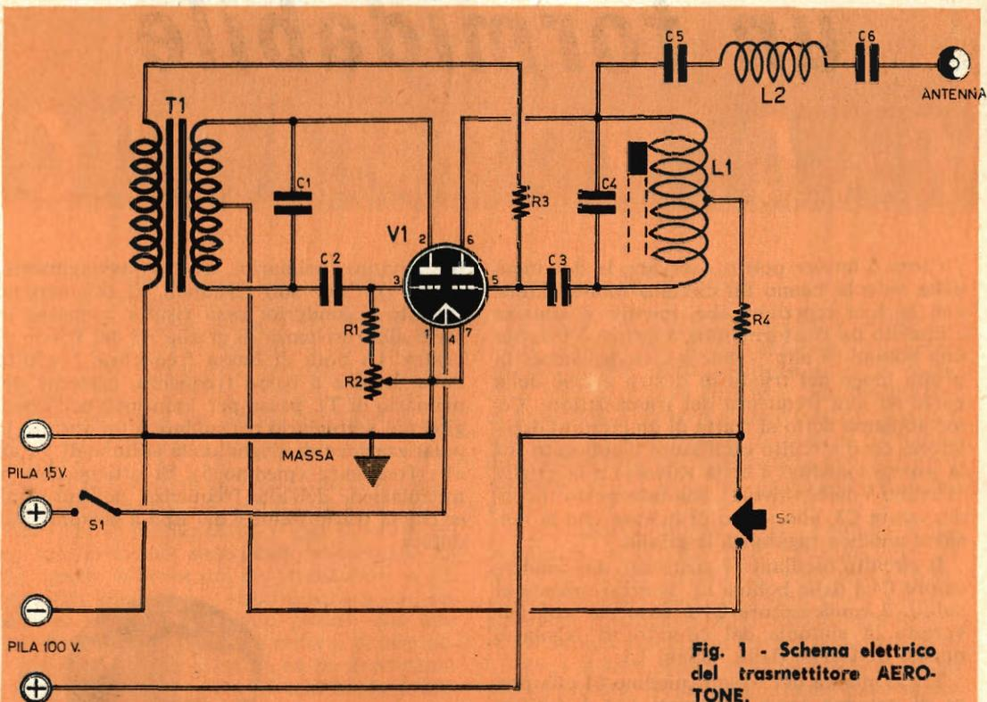
Fig. 1 - Schema elettrico del trasmettitore AERO-TONE.
