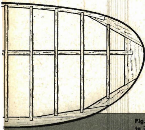
Fig. 5-6-7-8 - Tipi diversi di bordi d'entrata alare. Bordi d'entrata in copertura di balsa. Fazzoletti. Bordo d'uscita a « spezzati ».
